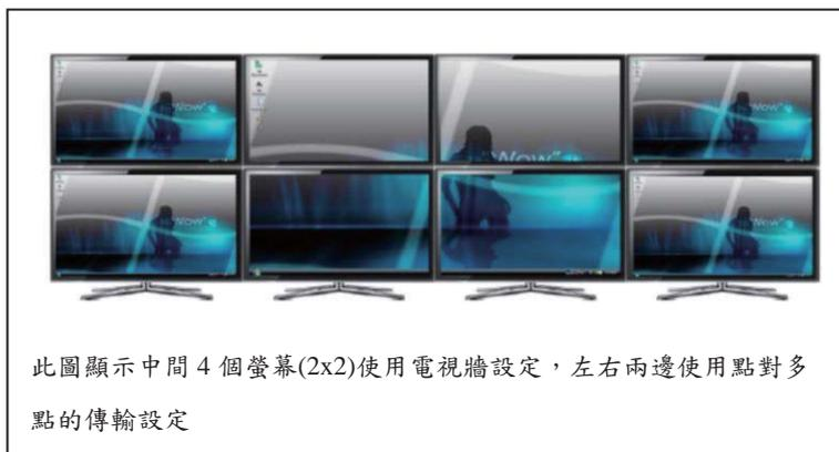
此圖顯示中間 4 個螢幕(2x2)使用電視牆設定，左右兩邊使用點對多點的傳輸設定
